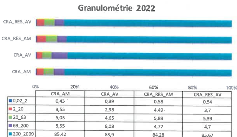
Analyse granulométrique des sédiments de 4 stations du Crazius – 2022
